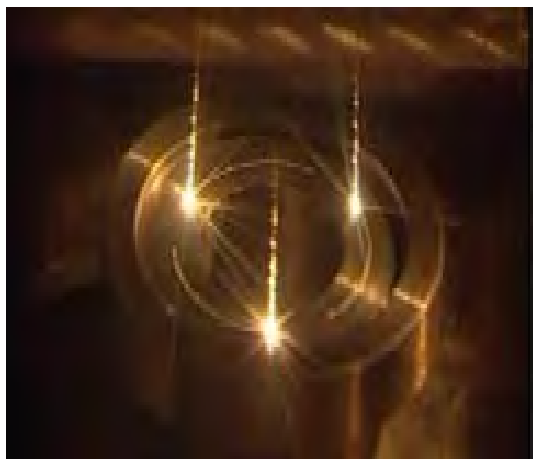
电子束高速扫描多点焊接
